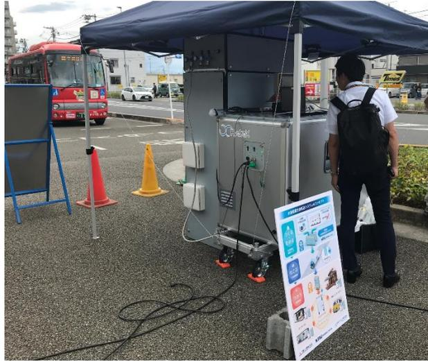
水素吸蔵合金ユニットと可搬型燃料電池システム
