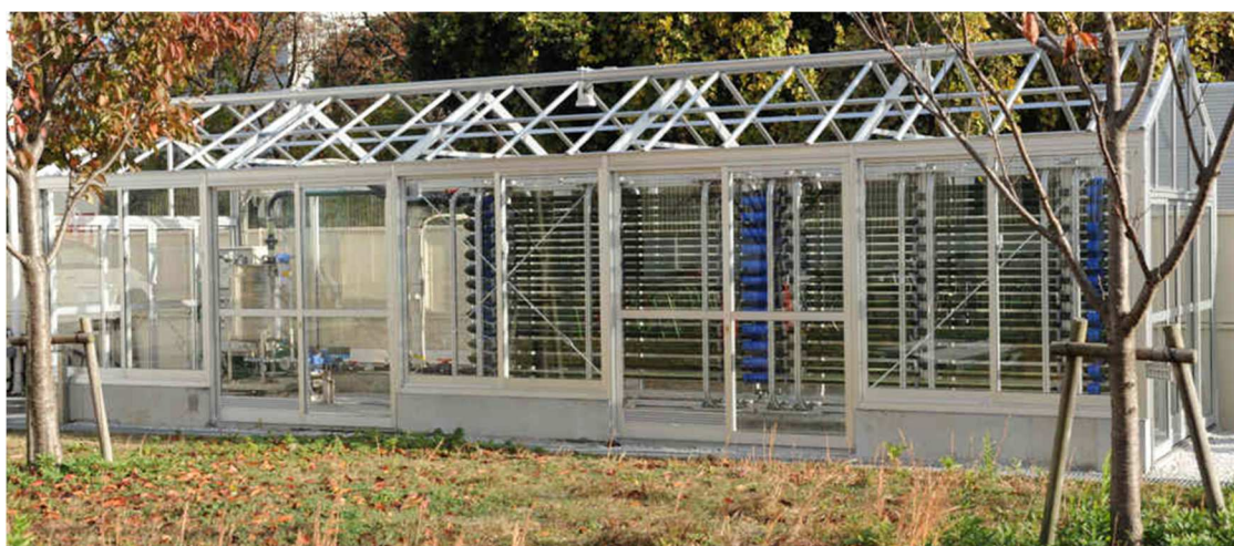
都市型藻類バイオマス生産プロセス技術開発を目指した実証試験用フォトバイオリアクター
