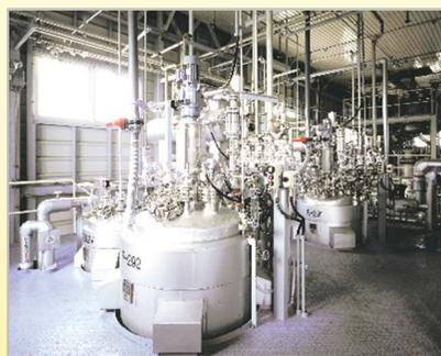
▶ 超低温合成反応装置
