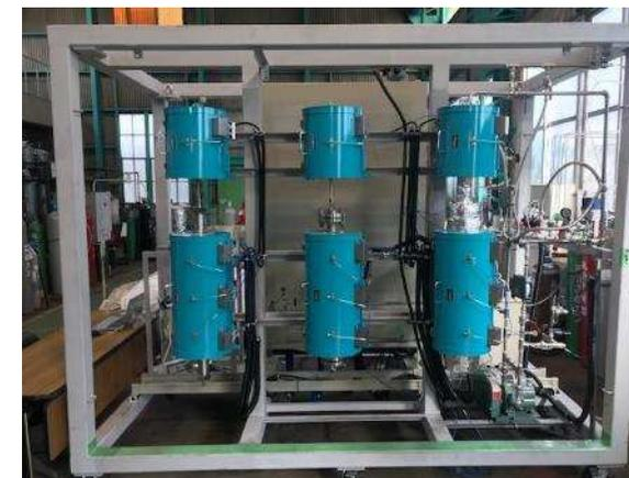
廃プラから得られる合成ガスの改質試験を実施中 ⇨ 2023年11月より廃プラガス化設備との連携運転実証予定
