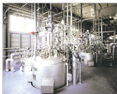
▶ 超低温合成反応装置
