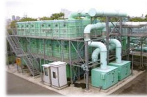
■ 超高速沈殿装置
